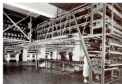
● Motta S.p.A. - stabilimento di Milano reparto panettoni forni di cottura e trasportatori per il raffreddamento
